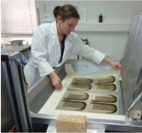
Im neuen Restaurierungsatelier in Ittingen bei Bern – Entnahme der angefaserten Buchseiten aus dem Anfasergerät.
